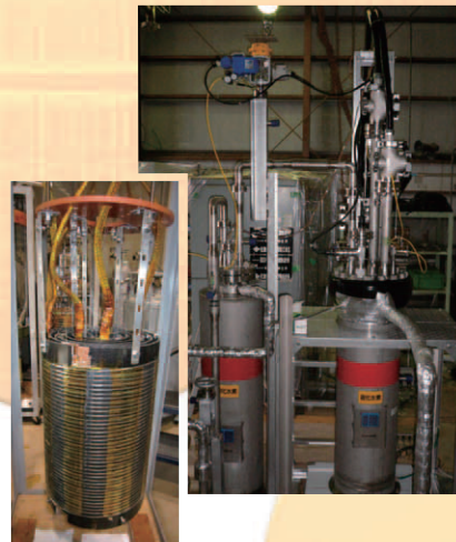
液体水素冷却超伝導材料特性実験装置 (上) と 三相高温超伝導限流器 (左)
