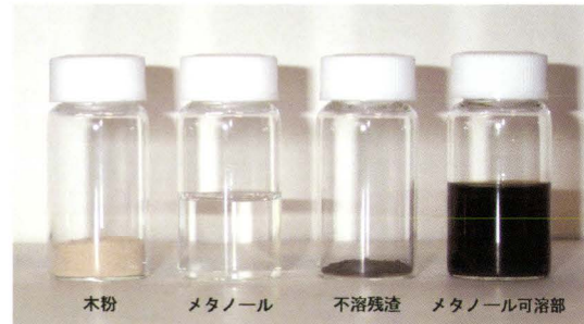
写真1 木材の超臨界メタノール処理で得たメタノール可溶部
