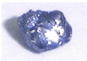
図1 本プロセスにより作製されたSiインゴット
