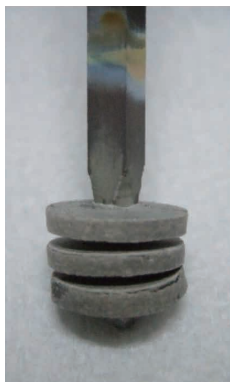
図1. 粉末シリカと粉末シリコンの混合物をドーナツ状にペレット化してシリコン棒に固定した電極
