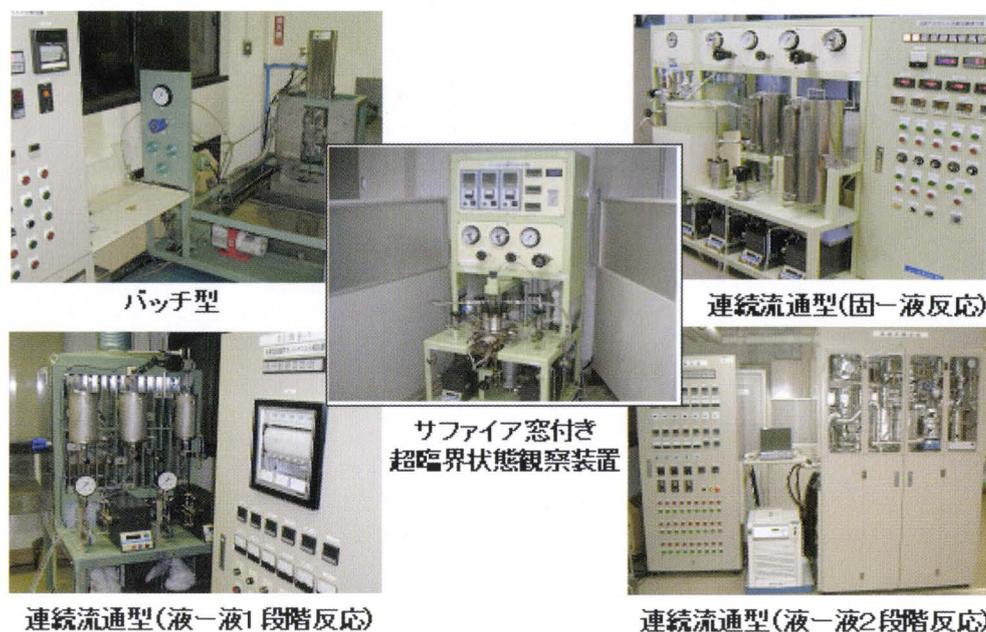
図4.5.3 各種超臨界流体バイオマス変換装置
