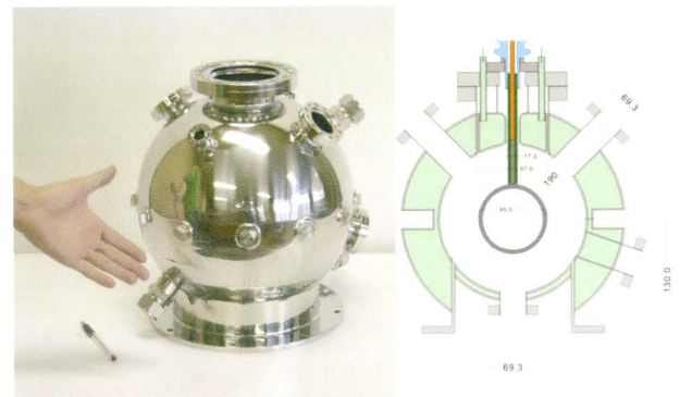
図3.1.22 冷却・中性子集束両用水冷ジャケット付き 地雷探査用超小型装置
