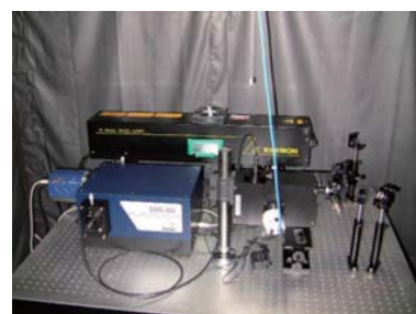
Fig. 4-9. Photoluminescence (PL) measurement system. 図4-9 今年度整備したPL測定システム
