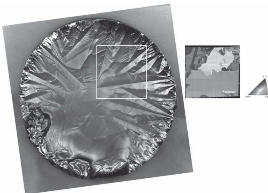
図1 Si インゴットの結晶表面に成長した稠密なデンドライト結晶とその下に成長した大きな結晶粒のEBSP像
