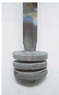
粉末シリカと粉末シリコンの混合物をドーナツ状にペレット化してシリコン棒に固定した電極
