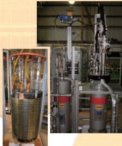
液体水素冷却超伝導材料特性実験装置（上）と
