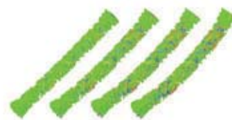
発泡金属の曲げ変形と崩壊プロセスの 直接シミュレーション
