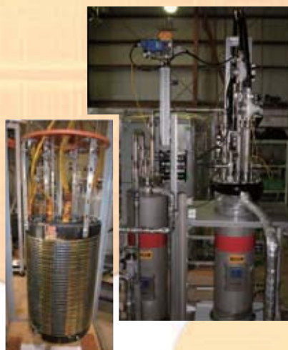
液体水素冷却超伝導材料特性実験装置（上）と 三相高温超伝導限流器（左）
