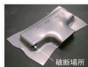
実測限界ストローク = 17.8 mm 実験結果
