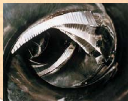
プラズマ加熱用 ICRF アンテナ
