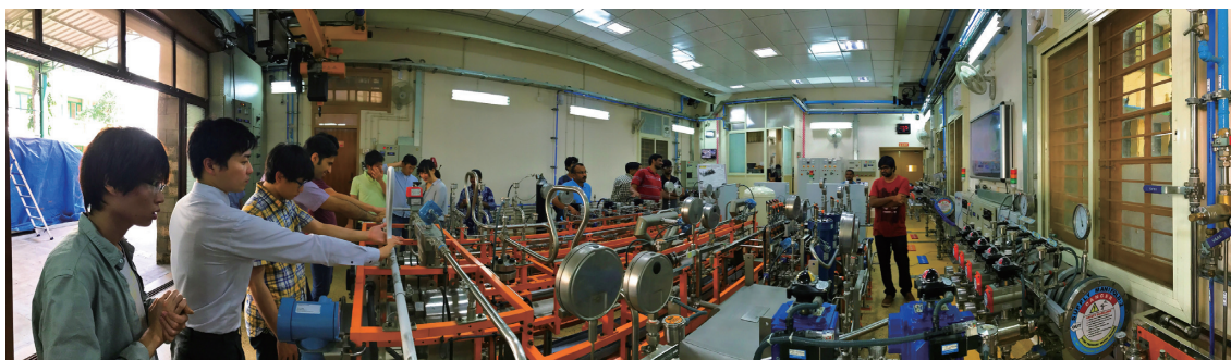
IISc の Bengaluru Campus に設置されている超臨界二酸化炭素テストループにて実演の様子
