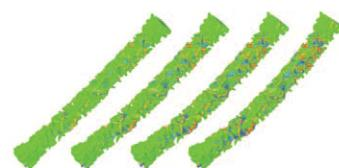
発泡金属の曲げ変形と崩壊プロセスの
