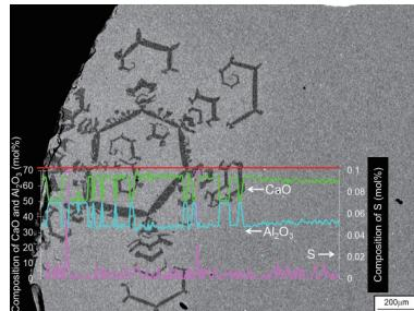
溶融 CaO-Al<sub>2</sub>O<sub>3</sub> スラグ中に S の影響によつて生成した結晶
