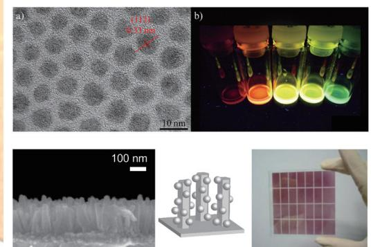
量子ドット（上）とナノロッドアレイ（左下）およびその複合材料（中）と太陽電池モジュール（右下）
