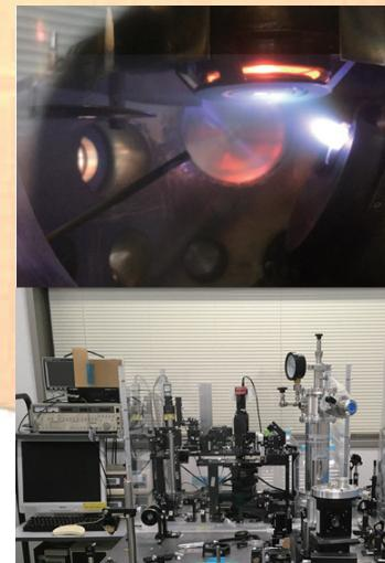
パルスレーザー蒸着による成膜の様子（上）と
